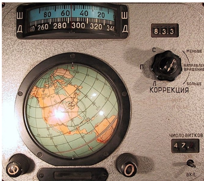
Рис. 1. Индикатор местоположения и места посадки «Глобус» на панели управления серии космических кораблей «Восход» (ArcGIS Blog, 2018).
